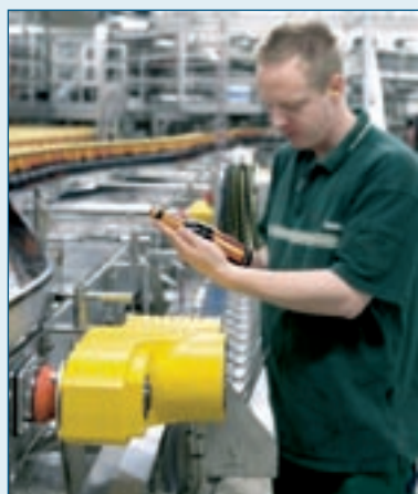
MOVIGEAR® SNI in der Ausführung als „Single Line Network Installation“ am Kastentransport; Fotos: SEW-EURODRIVE GmbH & Co.KG, Bruchsal
