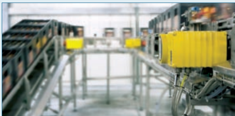
MOVIGEAR® SNI in der Ausführung als „Single Line Network Installation“ am Kastentransport; Fotos: SEW-EURODRIVE GmbH & Co.KG, Bruchsal
